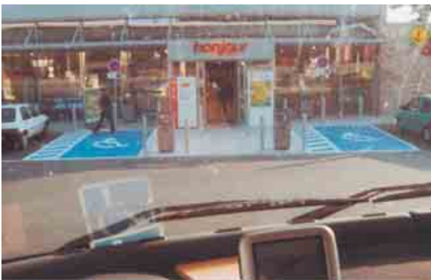
Italiassa huoltoaseman sisäänkäynnin molemmin puolin on selvästi erottuvat invaparkkiruudut.
